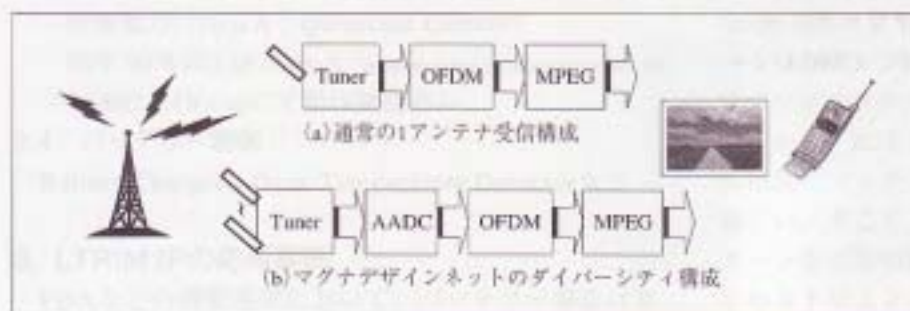
図1 地上デジタル放送の受信機構構成
