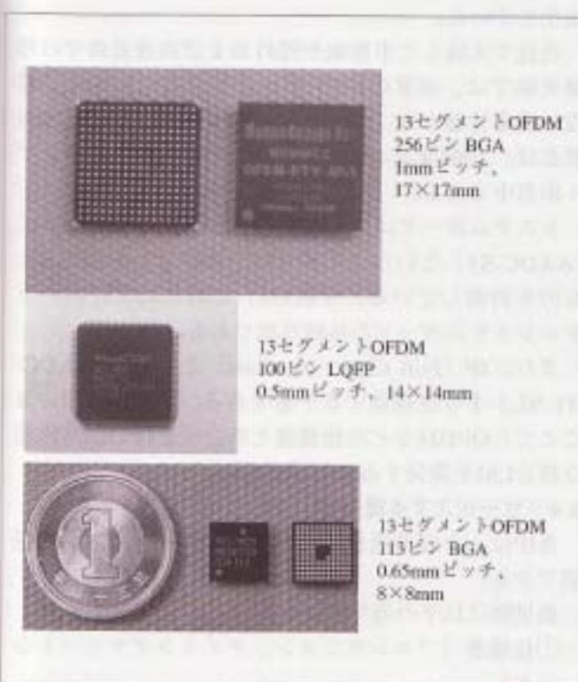
写真1 OFDM Receiver Chipの各種パッケージ外観写真
